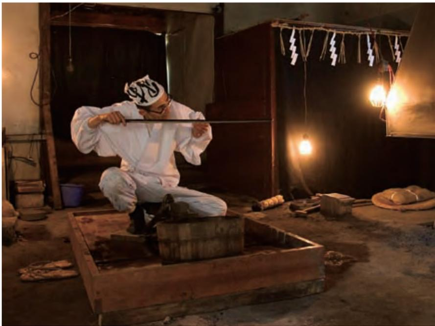
折れず、曲がらず、よく切れる、日本の刀の特徴は、素材の玉鋼を折り返し鍛錬し、刃に焼きを入れる独特の製作から生まれる。
