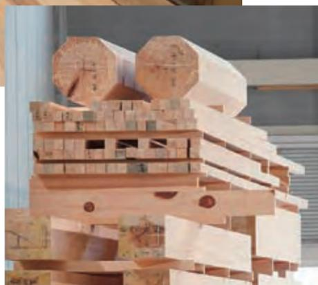
(上)神殿はだれの目にも触れない組み手の溝や柄穴の中まで美しく仕上げられる。(下)墨掛けのすんだご用材。
